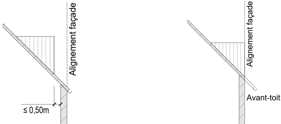
Figure 10 : positionnements en coupe des ouvertures en toitures (valables pour tous les types d'ouvertures)
