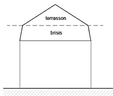
**Figure 31 : Toiture Mansardée traditionnelle**
