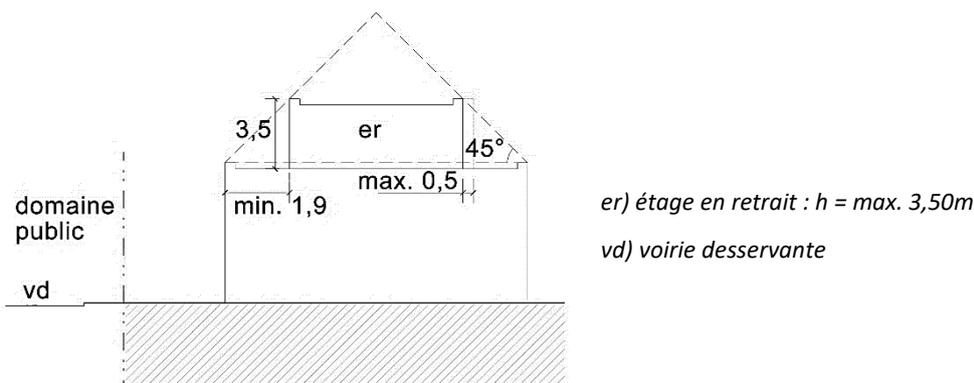
**Figure 3 : Décalage de l'étage en retrait**
