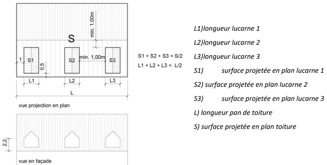
**Figure 6 : Ouvertures en toiture**
