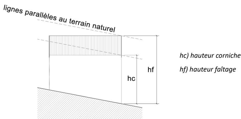
**Figure 11 : Hauteurs des constructions dans le cas de la voirie desservante en pente**
