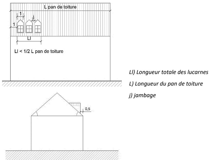
**Figure 15 : Ouvertures en toiture**
