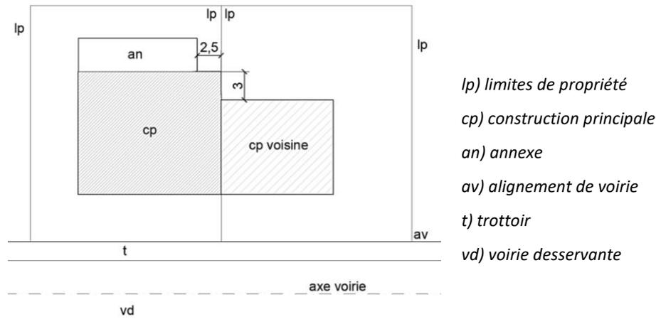
**Figure 1 : Construction accolée à une construction existante**
