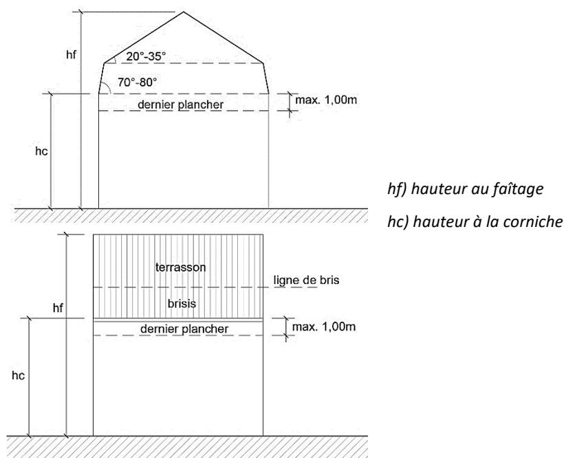
**Figure 5 : Toiture mansardée**
