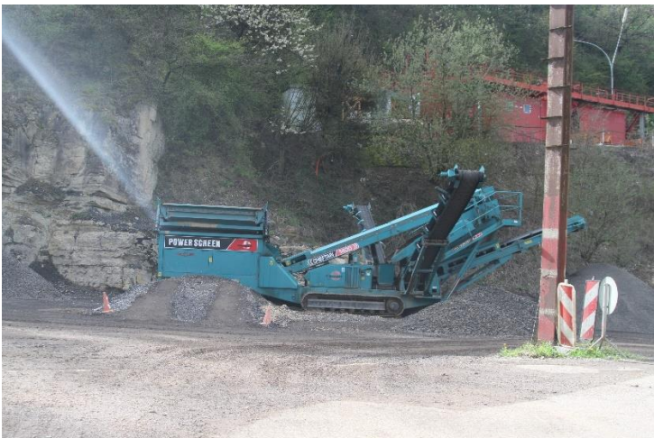
Abbildung 30: Siebanlage für Ausbauasphaltgranulat
