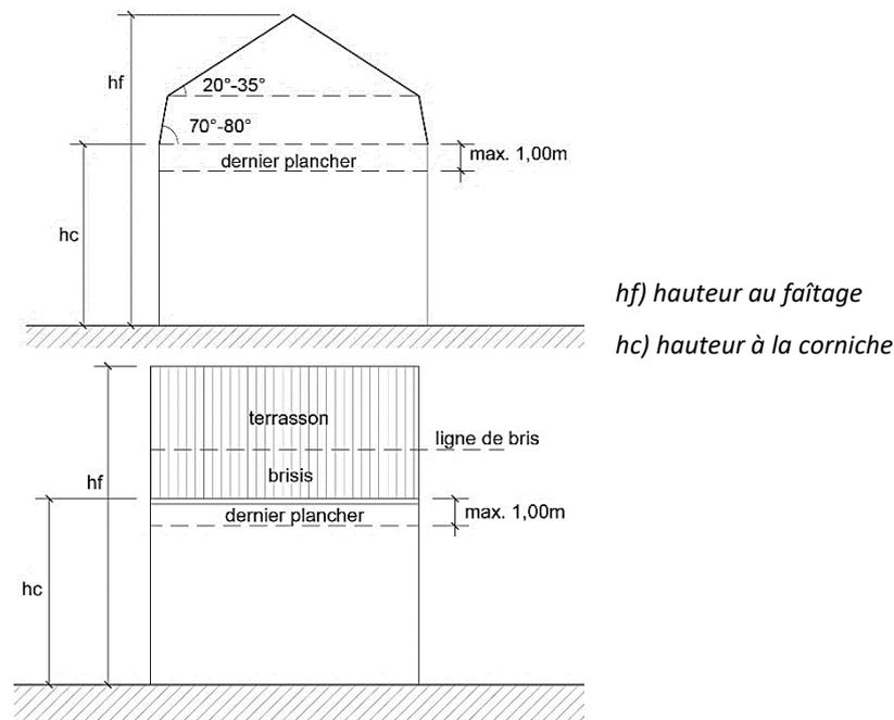
**Figure 4 : Toiture mansardée**
