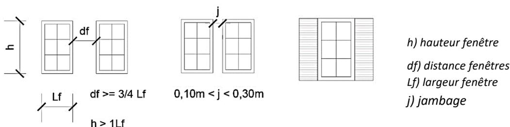
Figure 15 : Distance entre les ouvertures et volets rabattants
